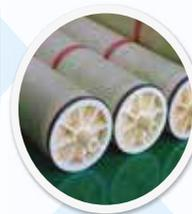
La membrana modelo ULP21-4040 desarrollada por Vontron Technology, tiene la capacidad de trabajar bajo presiones ultra bajas y obtener altos flujos de permeado y un alto rechazo de sales disueltas, siendo adecuadas para eliminar las sales de aguas con una concentración inferior a 2000 ppm, tales como agua superficial, agua de pozo profundo, agua municipal.
